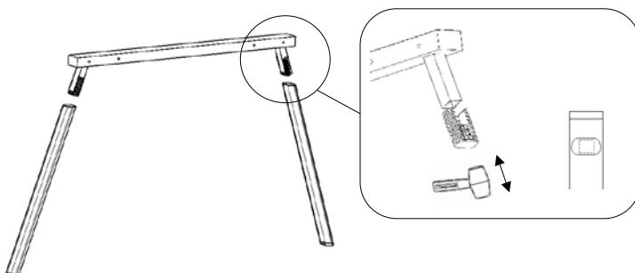
2. Fix the crossbars to the frame | Fissare i traversi alla struttura
